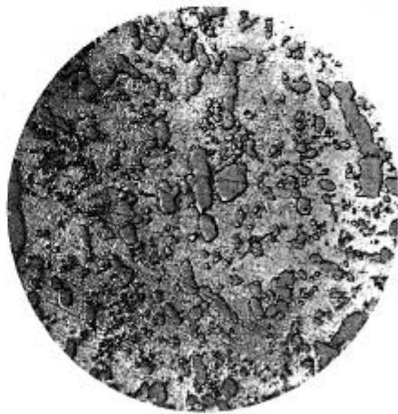
Рис. 14. \times 1000 Булатный клинокъ послѣковки.
