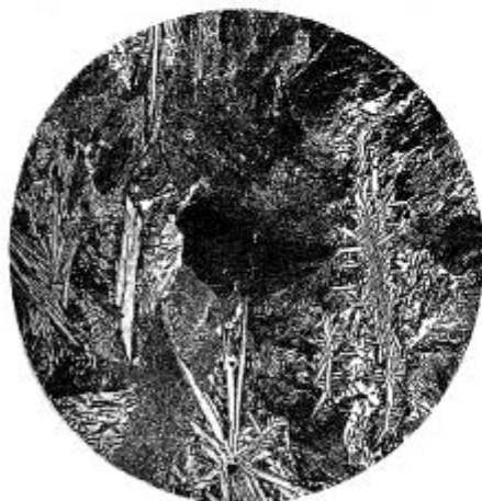
Рис. 13. \times 100 Булатный сутунокъ доковки.
