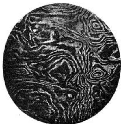
Рис. 11. \times 5 Булатный клинок № 2 из собрания Д. К. Чернова. (Кристаллизация и структура стали.)
