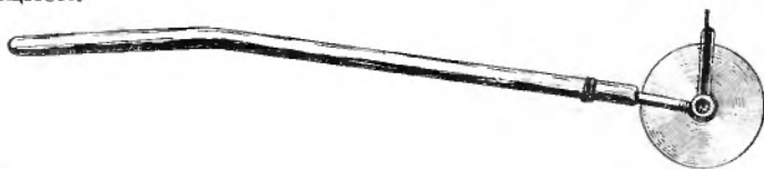
Рис. 201. Нож дисковый служит для нарезки дерна, обруб-ки краев дорожек, обрезки усов земляники.
