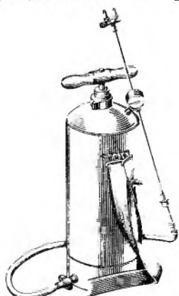
Рис. 153. Опрыскиватель ранцевый пневматический ОРП-Г.
