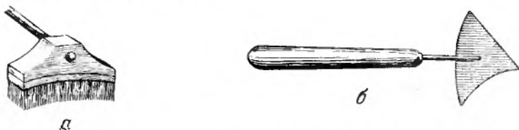
Рис. 109. Щетка стальная (слева) и скребок садовый универсальный для очистки ствола дерева.
